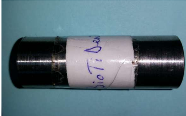
Fig. 2. Semifabricat bară turnată din materialul super elastic Ti20Nb20Zr4Ta
