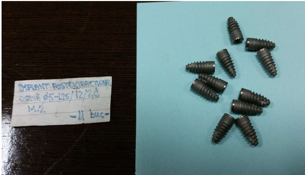
Fig. 6. Lotul de implanturi dentare ogivale BioTiDent, generația a II-a
